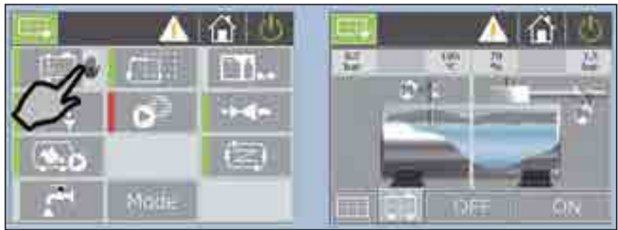
Рис. 6. В обзорном диалоговом окне SCO отдельные компоненты установки, например, бак питающей воды, многокотельные установки, подача топлива, отображаются легко узнаваемыми символами: прикосновение — и соответствующие компоненты выводятся на экран (на правом рисунке: бак питающей воды с дегазацией)
