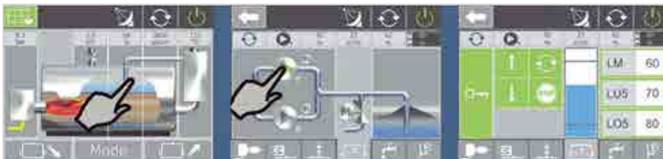
Рис. 3. После прикосновения к штуцеру питающей воды на следующих иллюстрациях управления можно изменить настройки насоса и параметры регулирования
