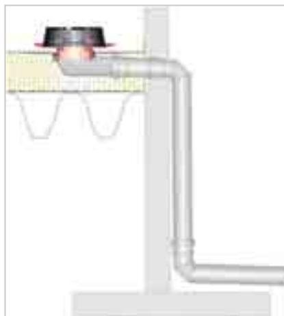
Система аварийного водостока на основе специальных воронок (HL64PowerSafe), устанавливаемых у парапета, с присоединенным вертикальным выпуском высотой 3 м
