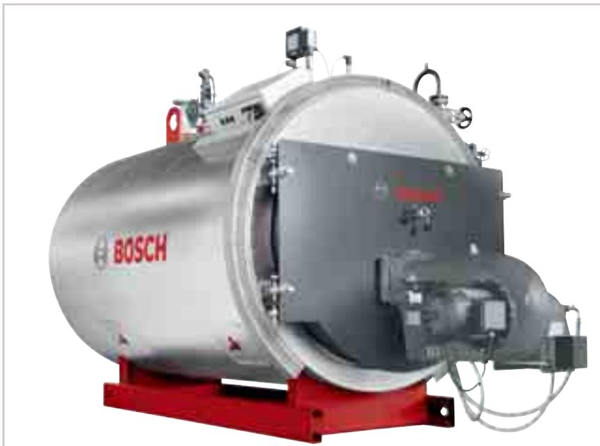
Bosch Universal U-HD — это жаротрубные паровые котлы высокого давления с реверсивной топкой. Котлы предназначены для работы на газе или легком жидком топливе и способны произвести от 175 до 3200 кг насыщенного пара в час при давлении корпуса котла до 16 бар.
