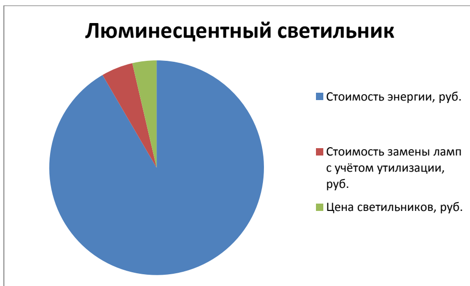
Рис. 3. Диаграмма распределения стоимости владения. Состав стоимости владения для люминесцентного светильника
